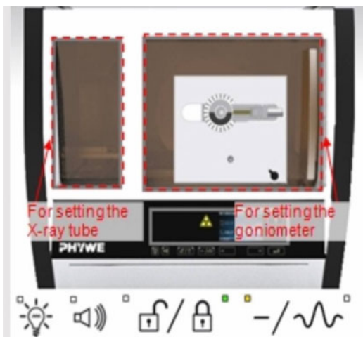
Рис. 14. Часть интерфейса ПО: справа – настройка параметров гониометра, слева – настройка параметров трубки
